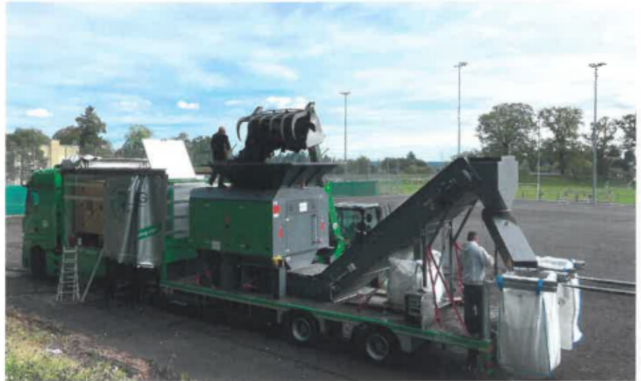
Beim mobilen Recycling wird das Elastikmaterial geschreddert, gesiebt, gesäubert und vor Ort in BigBags gelagert. | Foto: PR Recycling GmbH
