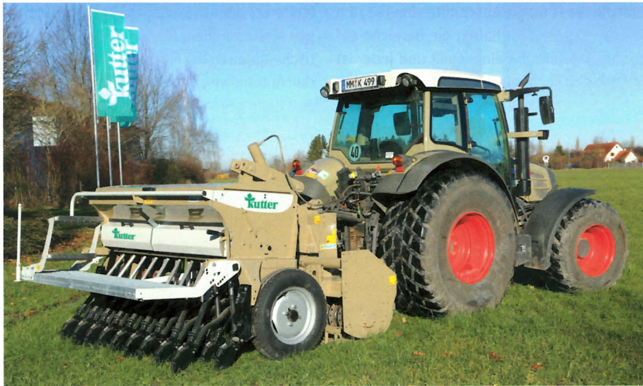
Sportplatzbauer Kutter stellte sein neu entwickeltes Pflögegerät VertiRadix erstmals der Öffentlichkeit vor. Es bringt Dünger in den untersten Wurzelraum ein und lockert gleichzeitig. | Fotos: Kutter
